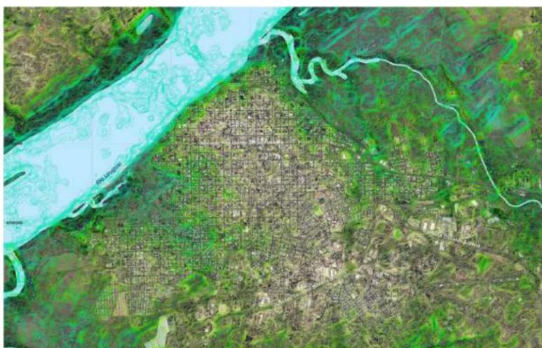
Courbes de niveau extraites du Modèle Numérique de Terrain ASTER GDEM-V2,
